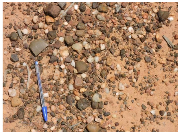
Foto 3.7 – Exposição de grânulos, seixos, blocos e matacões representativos de Depósitos Colúvio-eluviais. UTM 23 L 732651 E; 9066160 N. Foto: GEOCONSULT SOLUÇÕES AMBIENTAIS (2020).
