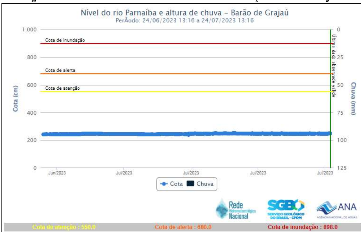
Figura 1 – Nível do Rio Parnaíba e altura de chuva – Estação Barão do Grajaú
