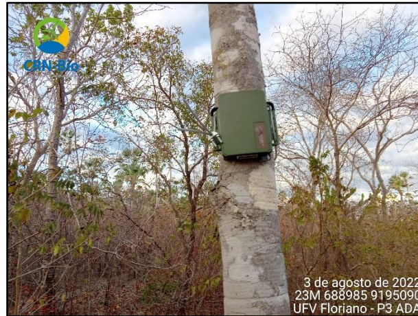
Figura 7.26: Gravador ultrassônico SongMeter para amostragem de morcegos Fonte: CRN-Bio, ago/2022.
