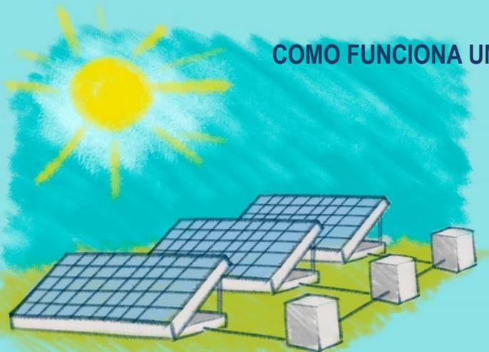
O **painel solar fotovoltaico** converte a luz do sol em energia elétrica (corrente contínua). O **inversor** converte a corrente contínua em corrente alternada.
