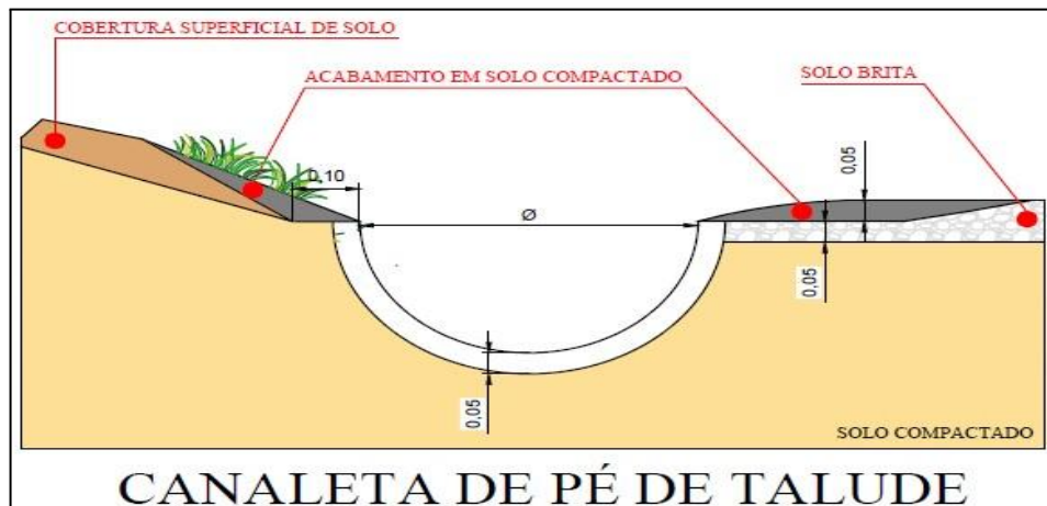
Figura 14.0 - Canaletas de concreto tipo meia-cana.
